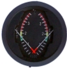
dvojitý CHT teploměr hlav válců
