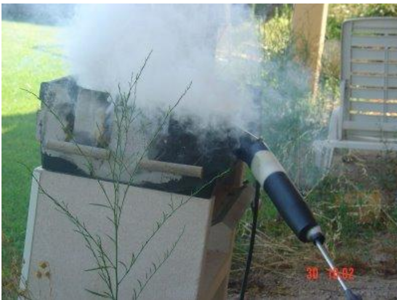
Solo con aire comprimido el frente de llama va avanzando por el tubo (nótese las zonas donde la pintura se ha vuelto blanca por el calor. Son las cámaras del laberinto del silenciador)
